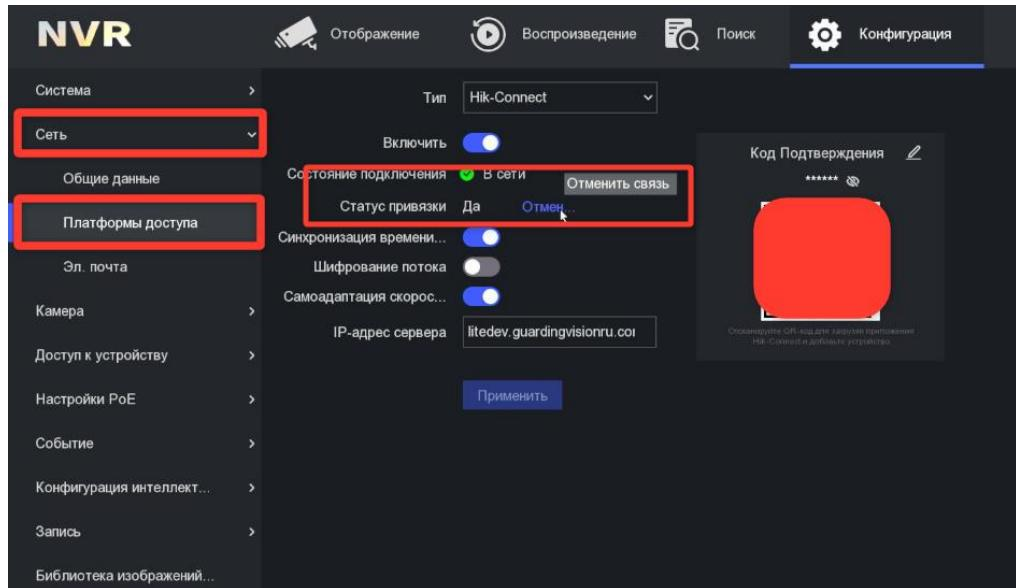
Так же у устройств с новой версией прошивки есть возможность отвязать и через WEB-интерфейс:
